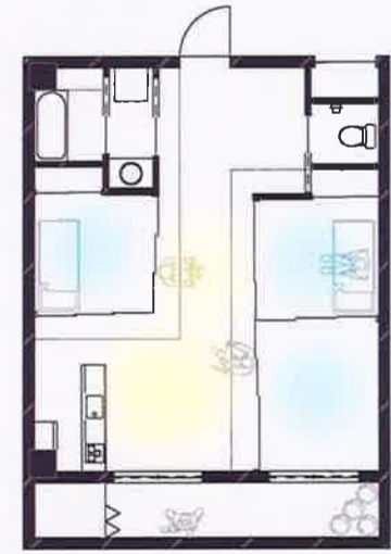
case4 戸を全て閉じる 個人の空間を最大限に確保しつつ、縁側を利用する事で会話の空間も確保できる。
